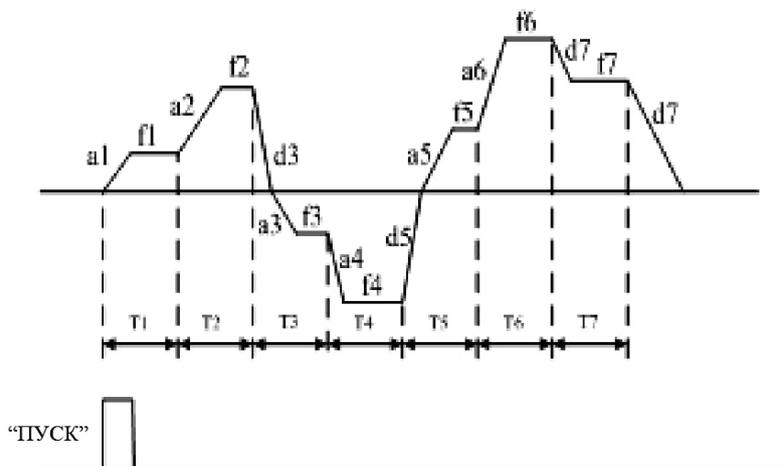
**Непрерывная работа в программном режиме (цикл за циклом)**
