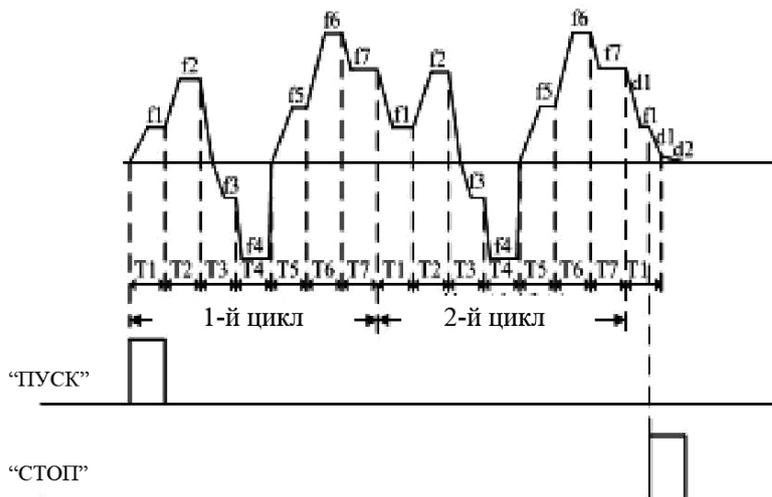
**Примечание:** Пояснения к приведенным выше диаграммам: an – работа преобразователя в режиме разгона электродвигателя, fn – работа преобразователя с постоянной выходной частотой, dn – работа преобразователя в режиме торможения электродвигателя, Tn – время работы преобразователя в соответствующем режиме.
