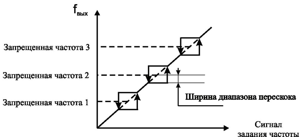
**Примечание:** Постоянная работа преобразователя на запрещенных частотах невозможна, но при разгоне и торможении запрещенные частоты не пропускаются, поэтому режимы плавного разгона и плавного торможения двигателя возможны.
