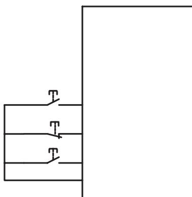
**3-проводной режим управления 1-ого типа (резерв):**
