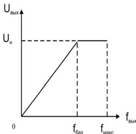
Базовая частота определяет значение номинальной частоты питающей сети электродвигателя. Базовая частота – это минимальная выходная частота преобразователя при его максимальном выходном напряжении. Максимальное выходное напряжение, соответственно, выходное напряжение преобразователя, соответствующее его базовой частоте, обычно соответствует номинальному напряжению сети электродвигателя.
