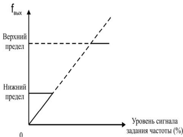
Данные функциональные параметры определяют значения максимума и минимума задаваемой опорной частоты преобразователя. При попытке установить опорную частоту, превышающую значение верхнего предела, она становится равной значению верхнего предела.
