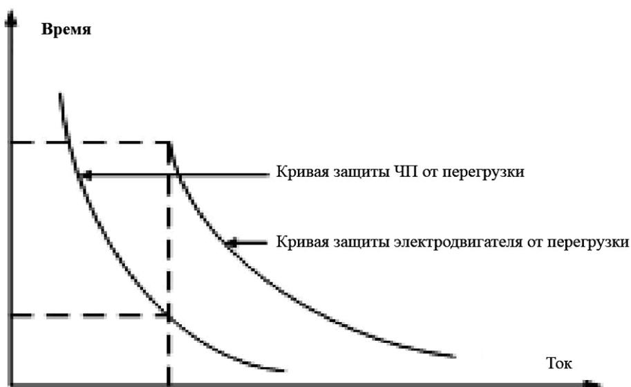
Если выходная мощность преобразователя больше мощности двигателя, то защиту двигателя от перегрузки необходимо осуществлять согласно нижеприведенной схеме:
